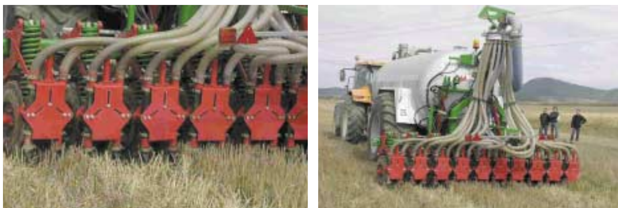
Figura 6. Aplicación de purín mediante inyección
