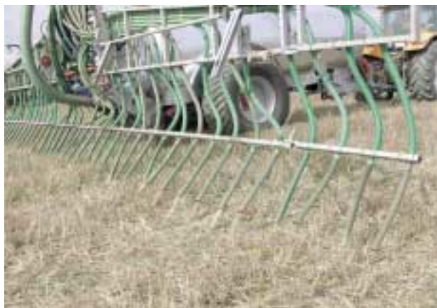
Figura 3. Aplicación de purín mediante el método de rampa con tubos colgantes
