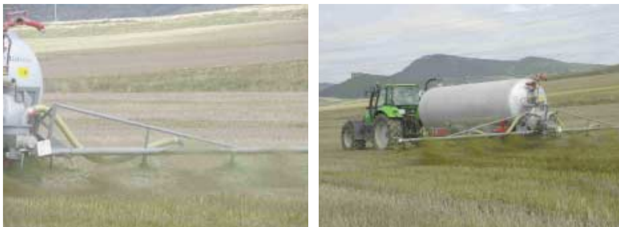
Figura 2. Aplicación de purín mediante la rampa multiboquilla
