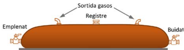
Figura 4. Connexions de la bossa flexible de purins.
