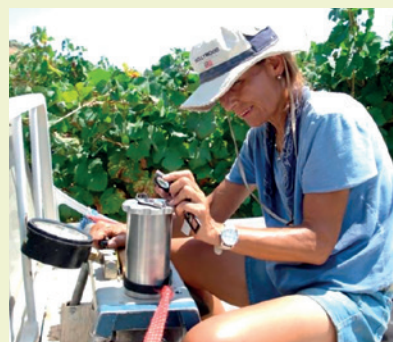
Figura 3. Tècnica de l'IRTA mesurant l'estat hídric de la vinya amb una càmera de pressió Scholander. Font: Programa Ús eficient de l'aigua de l'IRTA.
